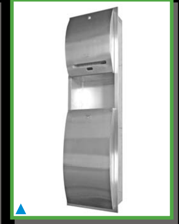
ST-602 EF Paslanmaz Çelik Fotoselli Kağıtlık ve Çöp Kovası Sıva altı, kilitle, pilli ve elektrikli. Ölçüler : 1235 x 362 x 247mm. Duvar açıklığı : 1200 x 300 x 165mm. ST-603 F Sıva üstü model.
