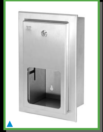
ST-800 SA Paslanmaz Çelik Sıva Altı W.C. Kağıtlık İkili, kilitli. Ölçüler : 320 x 195 x 128mm. Duvar açıklığı : 280 x 155 x 110mm.
