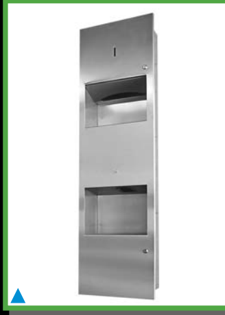
STC-3110-2 Paslanmaz Çelik Manuel Kağıtlık ve Çöp Kovası Sıva altı, fotoselli el kurutmalı, kilitle. Ölçüler : 1416 x 385 x 165mm. Duvar açıklığı : 1370 x 340 x 148mm.
