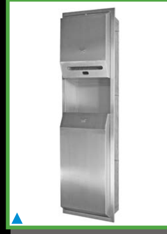
STT-1327 Paslanmaz Çelik Fotoselli Kağıtlık ve Çöp Kovası Sıva altı, kilitle, pilli ve elektrikli. Ölçüler : 1235 x 342 x 232mm. Duvar açıklığı : 1185 x 292 x 232mm. STT-1328 Sıva üstü model.
