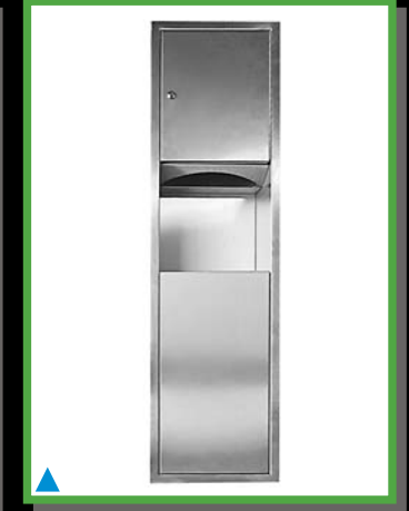
ST-125 Paslanmaz Çelik Manuel Kağıtlık ve Çöp Kovası Sıva altı, kilitle. Ölçüler : 1250 x 337 x 105mm. Duvar açıklığı : 1200 x 290 x 95mm.
