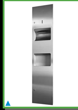
ST-64623-6 Paslanmaz Çelik Manuel Kağıtlık ve Çöp Kovası Sıva altı, kilitle. Ölçüler : 1535 x 335 x 130mm. Duvar açıklığı : 1495 x 295 x 115mm.
