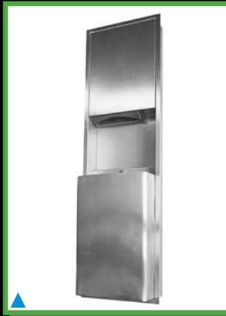
ST-64628 Paslanmaz Çelik Manuel Kağıtlık ve Çöp Kovası Sıva altı, kilitle. Ölçüler : 1425 x 430 x 210mm. Duvar açıklığı : 1370 x 390 x 95mm.
