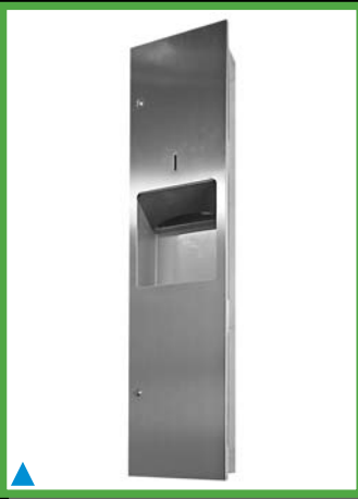
ST-64623 Paslanmaz Çelik Manuel Kağıtlık ve Çöp Kovası Sıva altı, kilitle. ST-64623-70 : 720 x 360 x 130mm. Duvar açıklığı : 670 x 330 x 115mm. ST-64623-100 : 1000 x 360 x 130mm. Duvar açıklığı : 950 x 325 x 115mm. ST-64623-140 : 1410 x 335 x 130mm. Duvar açıklığı : 1360 x 290 x 115mm.
