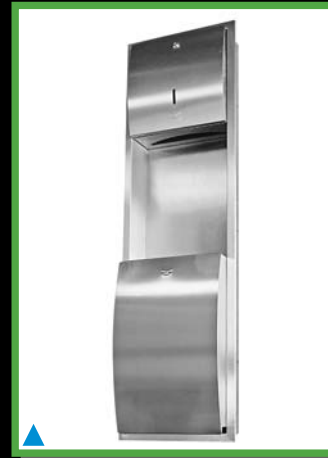
ST-602 E Paslanmaz Çelik Manuel Kağıtlık ve Çöp Kovası Sıva altı, kilitle. Ölçüler : 1160 x 350 x 186mm. Duvar açıklığı : 1115 x 310 x 100mm.
